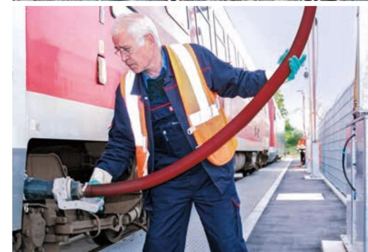
Die besonders kompakt ausgelegten TUnits von Vogelsang sind mit einem automatischen Schlauchrückzugsystem ausgestattet und erleichtern somit die Arbeit des Servicepersonals enorm.
